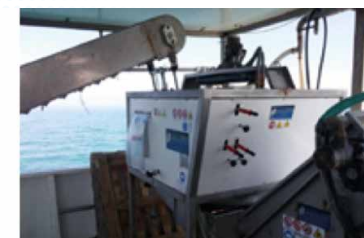
Fig. 31 - Sgranatrice a bordo di una imbarcazione impiegata per la mitilicoltura.
