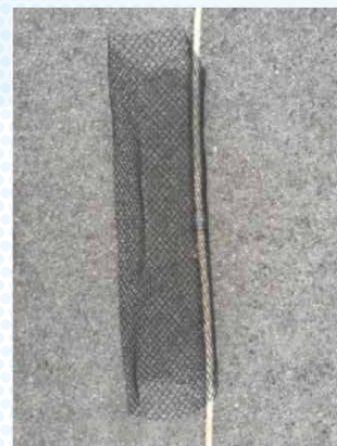
Fig.15 - 1° tipo di collettore con rete
